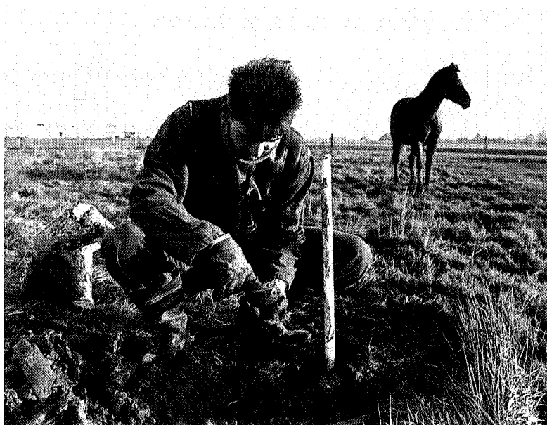
De peilbuis is geplaatst en er worden nog enkele grondmonsters genomen.
