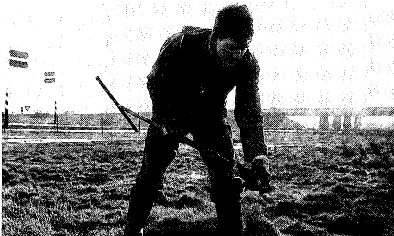
De met de grondboor omhooggehaalde aarde wordt goed bekeken: een verdachte kleur kan vervuiling betekenen.
