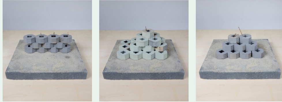
vlnr. sedimentvanger, mosselbank en golfbreker
